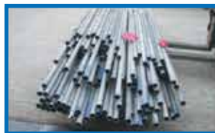
▶ 2重巻で止められていない
